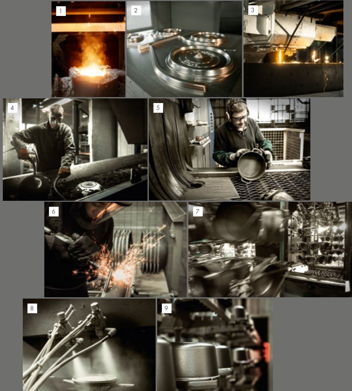
1. Schmelzen | 2. Formenbau | 3. Sandguss: Die Sandform kann nur einmal verwendet werden und wird für jeden Guss neu erstellt | 4. Lösen der Gussteile aus der Form und Entfernen von überschüssigem Metall | 5. Reinigungsstrahlen entfernen den Formsand | 6. Entgraten: Hier werden Unebenheiten entfernt | 7. Kugelstrahlen als Vorbereitung für die Emaillierung | 8. Emaillierung in 2 bis 3 Schichten, innen und außen | 9. Brennen bei 800 °C für 30 Minuten
